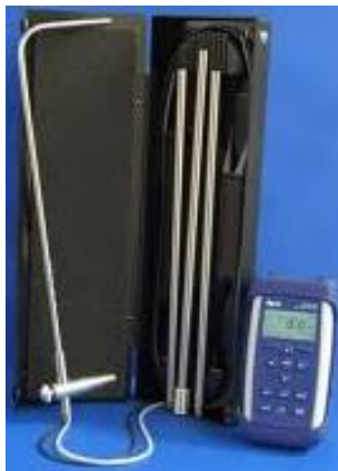
شکل (۳۲-۱) نمونه‌ای از لوله پیتوت با اندازه‌گیری اختلاف فشار
