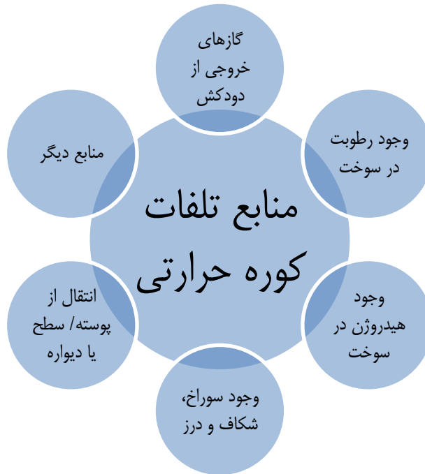
شکل (۳-۵۶) انواع تلفات انرژی در یک کوره حرارتی
