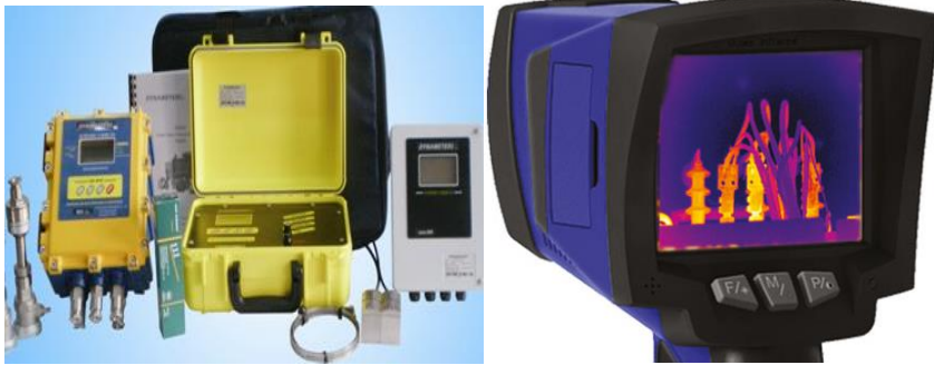
شکل (۱-۳۶) تجهیزات نمونه ممیزی انرژی حرارتی و مکانیکی در یک نگاه
