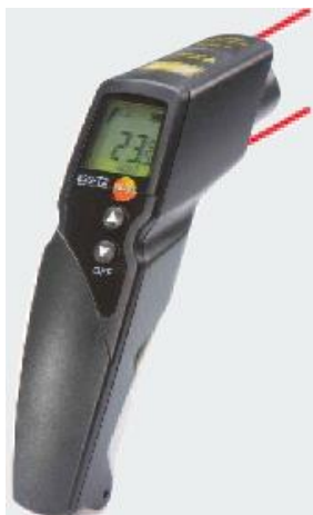
شکل (۱-۲۱) نمایی از یک دستگاه ترمومتر غیر تماسی (مادون قرمز) نمونه
