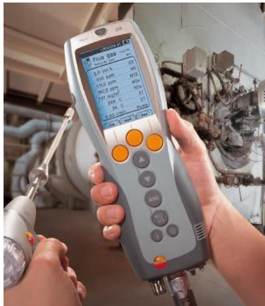
شکل (۱-۲۴) نمایی از یک نمونه Gas Analyzer
