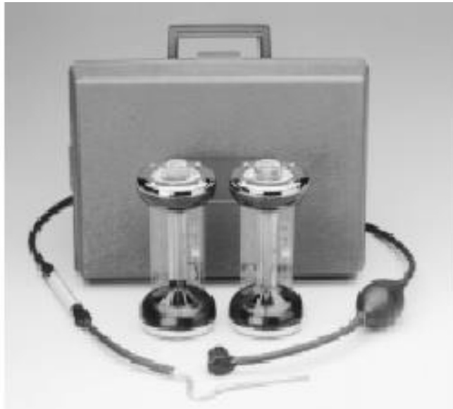
شکل (۱-۲۳) نمایی از یک نمونه Fyrite
