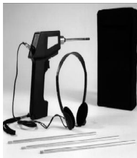
شکل (۱-۲۵) نمونه ای از یک تستر سلامت تله بخار
