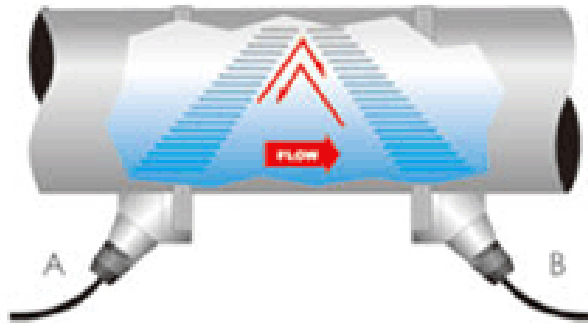
شکل (۱-۲۹) مکانیزم اندازه گیری دبی سنج مافوق صوت نوع زمان گذر
