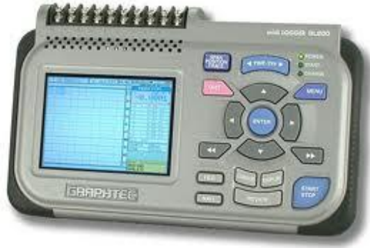
شکل (۱-۳۱) نمونه‌ای از یک دیتالاگر
